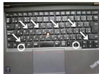
図 2: キーボードを外すときに外すネジ
