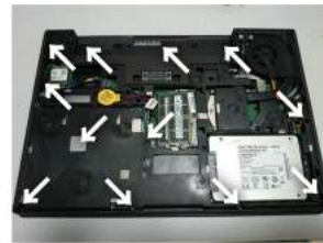
図 1: ベゼルを外すときに外すネジ
